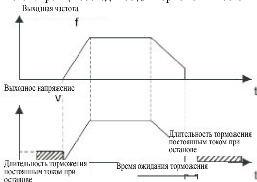
Рис. 6.3 Диаграмма торможения постоянным током
