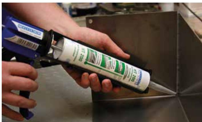
Серия FLEX 310M – это однокомпонентные и двухкомпонентные клеи и герметики на MS-полимерной основе.
