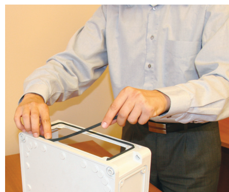
3. Установите уплотнитель на оба объединяемых корпуса
